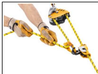
La poulie-bloqueur intégrée, avec réa de très gros diamètre sur roulement à billes étanche, dispose d'un sens de rotation unique et assure un excellent rendement au hissage.
